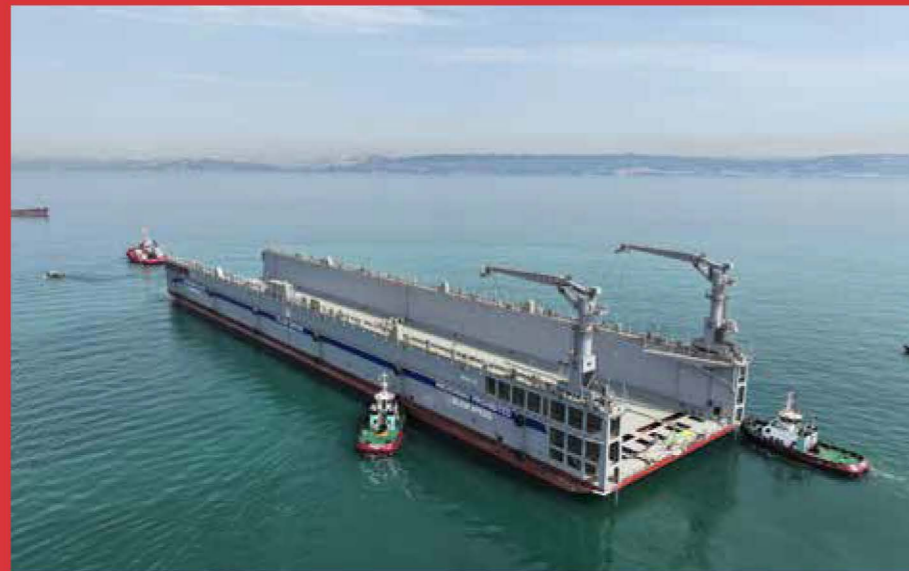
NB22 BLRT DOCK 10.000 TLC - 180 x 30 m
